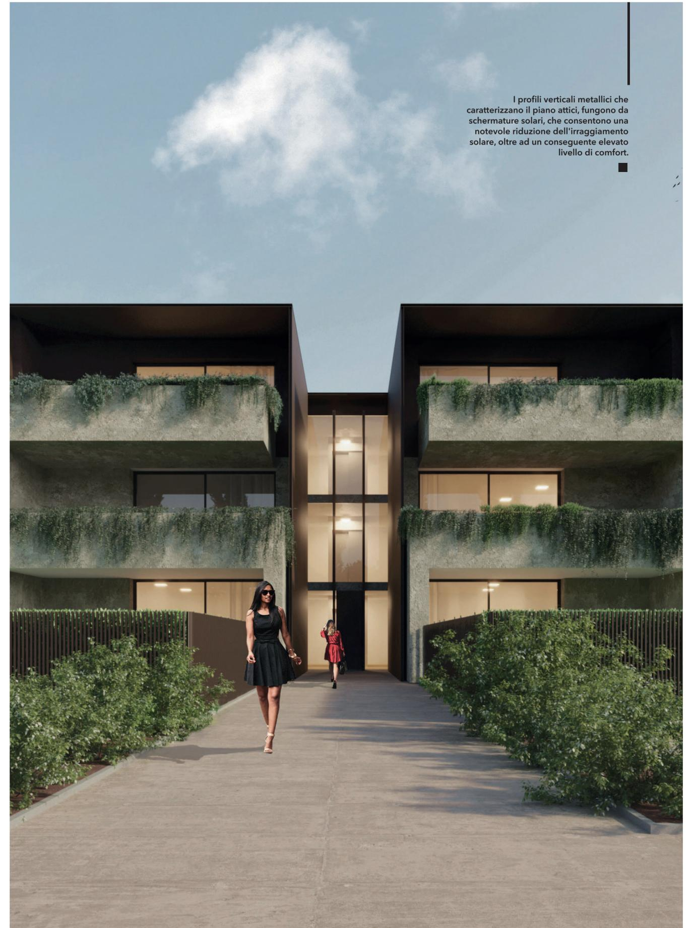
I profili verticali metallici che caratterizzano il piano attici, fungono da schermature solari, che consentono una notevole riduzione dell'irraggiamento solare, oltre ad un conseguente elevato livello di comfort.
